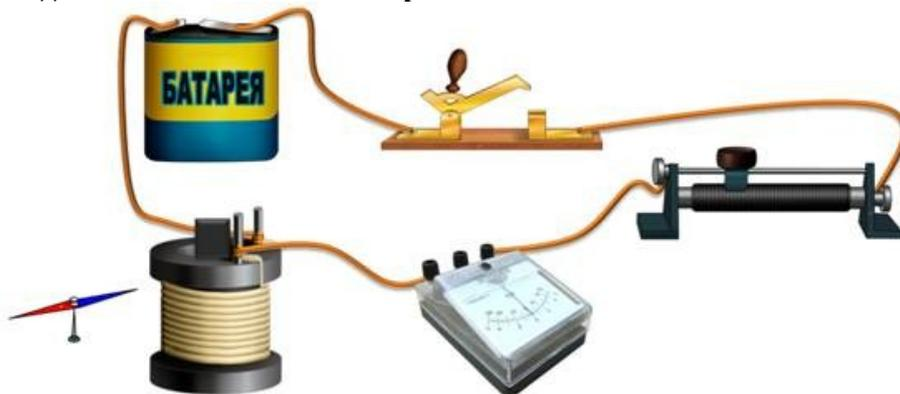
Вставьте в одну из катушек железный сердечник и закрепите его там, например гайкой. Далее подключите эту катушку через миллиамперметр, реостат и ключ к источнику питания.
